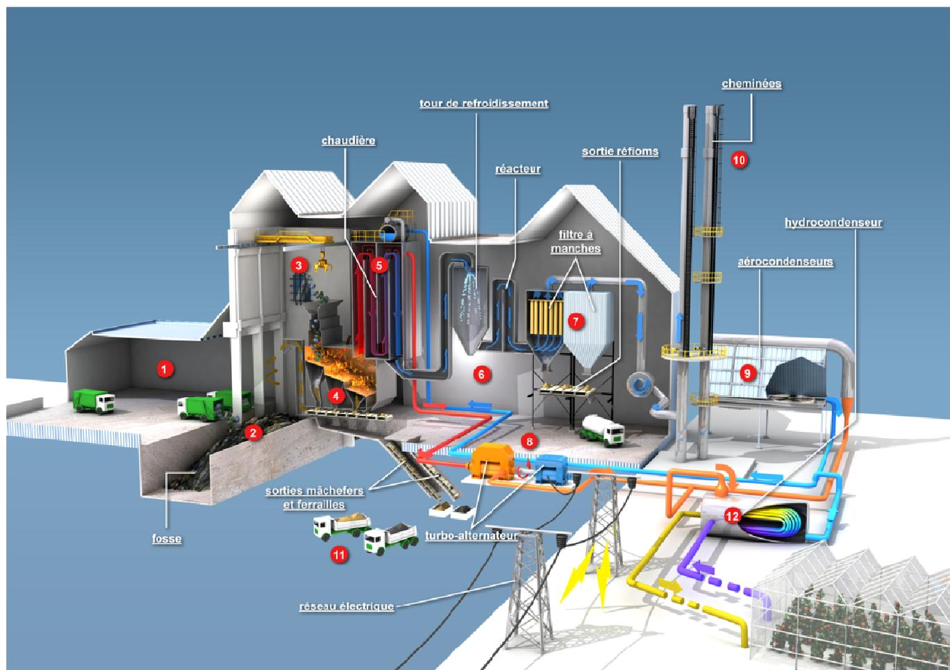
Chaque camion entrant sur le site est identifié, pesé et passe ensuite le portail de détection de radioactivité. Il vient benner son chargement dans une fosse (2). Les déchets sont alors repris par un grappin (3) et déposés dans les fours. L'unité est constituée de deux lignes de traitement des déchets comprenant chacune :
